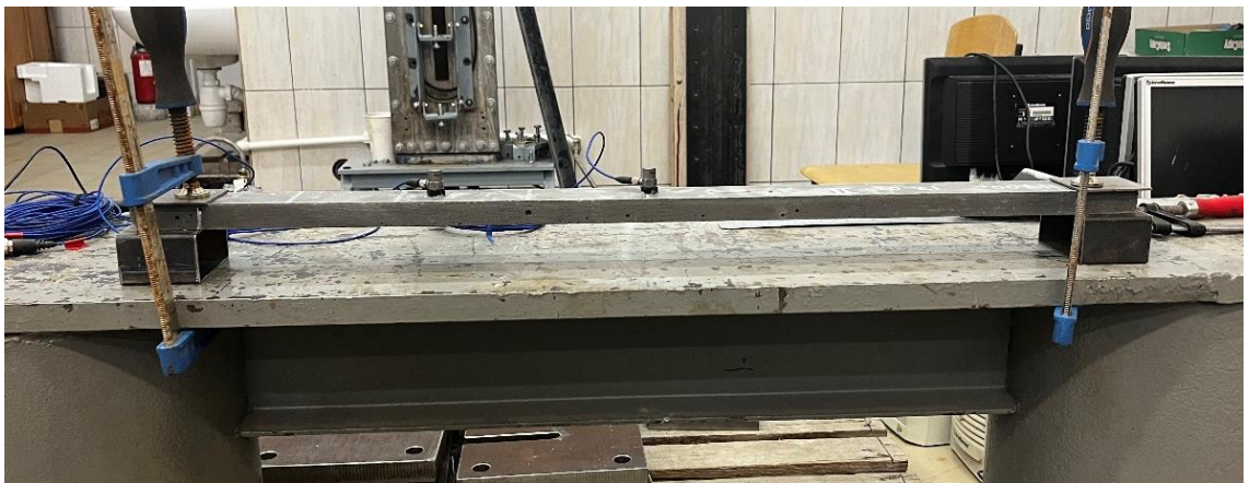
Рисунок 4.3 – Экспериментальная установка – балка жестко зацементированная по концам
