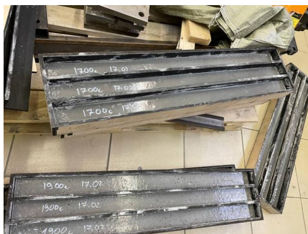
Рисунок 4.1 – рассматриваемые балки в опалубке
