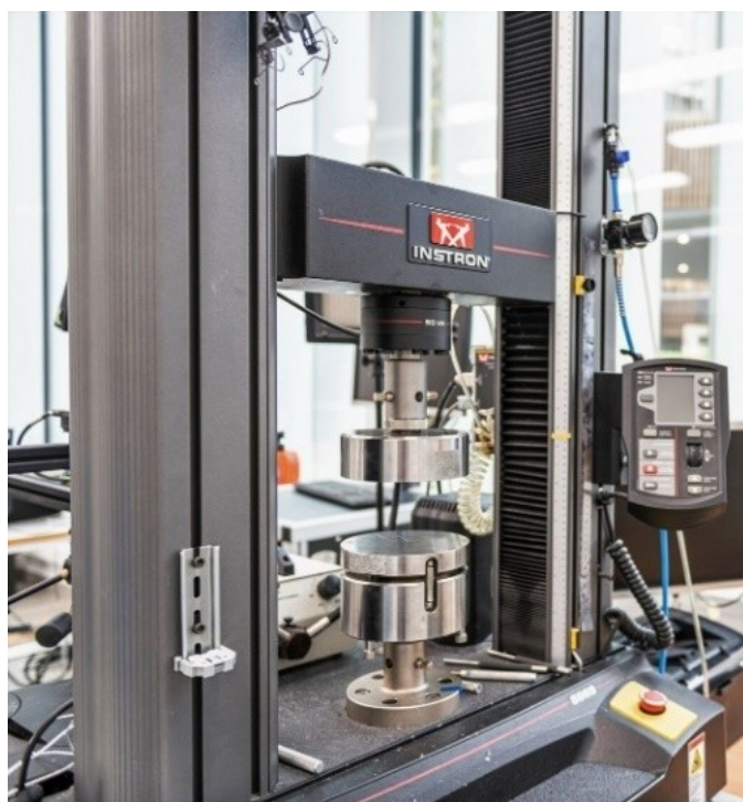
Рисунок 4.7. Испытательное оборудование Instron 5969 для проведения испытаний на сжатие (ASTM E9) и трёхточечный изгиб (ASTM D790).
