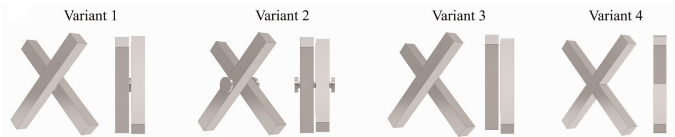
Рисунок 3.2. Варианты связей заполнителя. Слева направо: жёсткое соединение, шарнирное соединение, отсутствие связей, стандартная решётка (идеальное пересечение).
