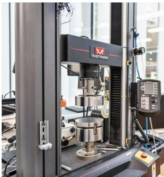
Рисунок 4.7. Испытательное оборудование Instron 5969 для проведения испытаний на сжатие (ASTM E9) и трёхточечный изгиб (ASTM D790).
