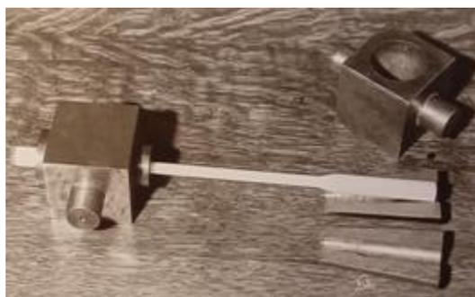
Рис.3. Захваты и образец для испытаний на растяжение.
