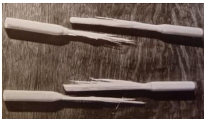
Рис.5. Разрушение у захватов.
