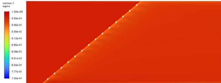
Рис.10. Поле распределения коэффициента восстановления полного давления при значении  $\lambda_0=0,2$ .
