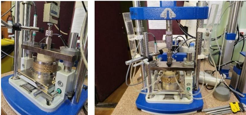
Рис.8. Сборка комплекса АСИС для испытаний на многоплоскостной срез (ООО НПП «Геотек»).
