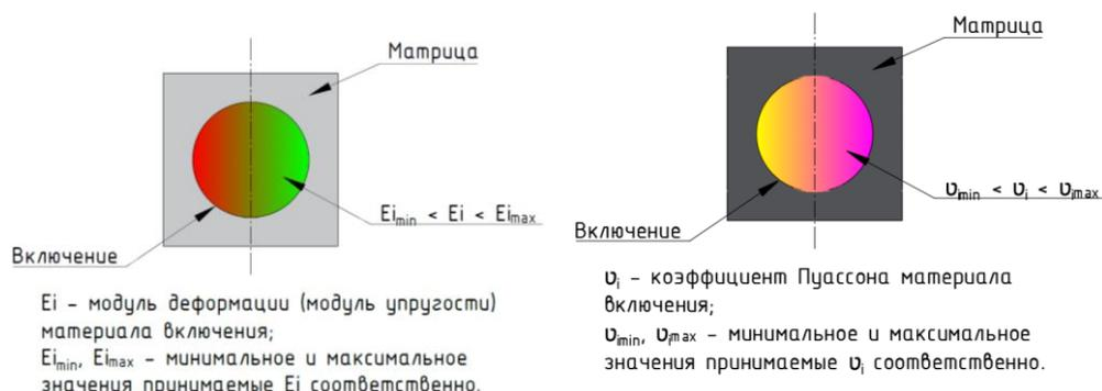
Рис.1. Периодическая ячейка композитного материала с включением.
