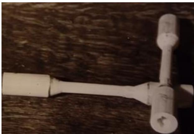
Рис.6. Характер разрушения образцов  $d=12$  мм.
