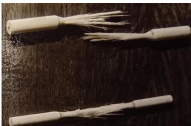
Рис.4. Разрушение в рабочей зоне образца.
