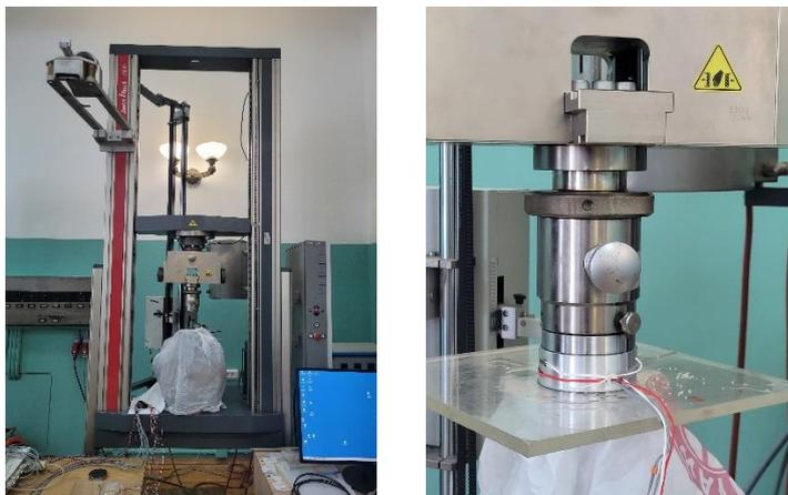
Рис.1. Проведение опыта на сжатие песка в оболочке в испытательной машине Zwick Z100.
