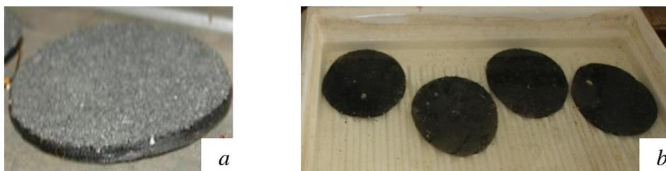
Рис.4. Гидроизоляционная мембранная кровля (а) в водной среде (b).
