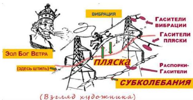
Рис.1. Вызываемые ветром колебания проводов воздушных линий.
