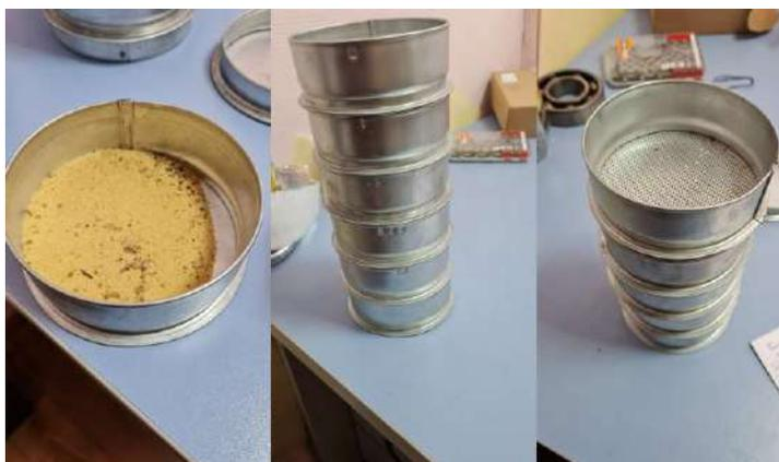
Рис.4. Определение гранулометрического состава песка.
