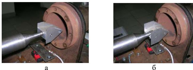
Рис.4. Фотографии размещения моделей в рабочей части трубы: а) оптимальное тело; б) псевдооптимальное тело.
