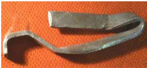
Пр.3.5. Пружинный замок, деформированный и выпавший из гнезда шапки изолятора, из-за подброса и изгиба поддерживающей гирлянды (при синфазных колебаниях в соседних пролетах).
