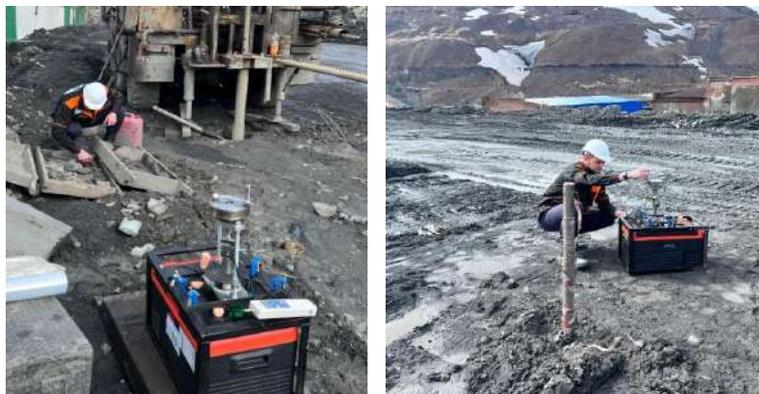
Рис.6. Фото проведения испытаний мерзлого грунта с помощью разработанного прибора в полевых условиях, непосредственно в месте отбора кернов из скважины.
