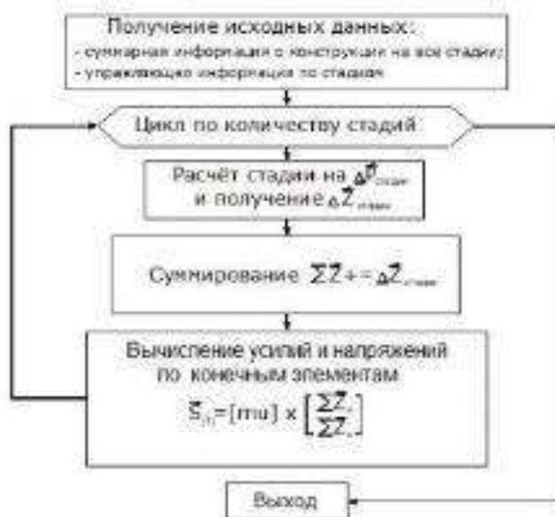
Рис.2. Вычислительный алгоритм учёта стадийности возведения, построенный на принципе суперпозиций.
